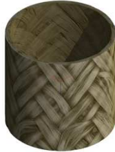
Hochauflösender 3D-CT-Scan: mehrlagig flechtpultrudiertes Rohr aus Glasfasern mit thermoplastischer Matrix
