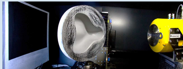
Vorbereitung des CT-Scans des drapierten Carbon Geleges
