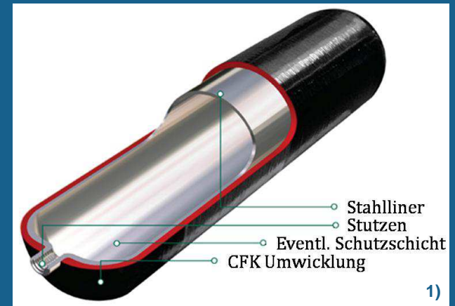
CNG-Tank schematisch
