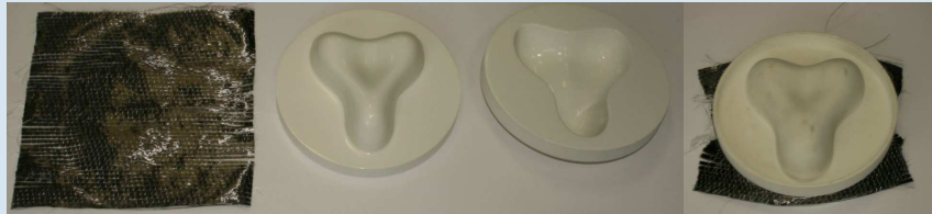
Drapieren eines unidirektionalen Geleges über eine komplex geformten Sattel-Geometrie (starke Änderungen in der Faserorientierung und Faserverteilung)
