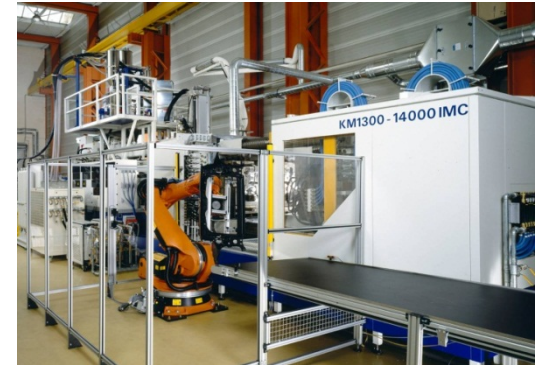
Krauss-Maffei-Spritzgießcompounder FhG-Pilotanlagenzentrum PAZ Schkopau
