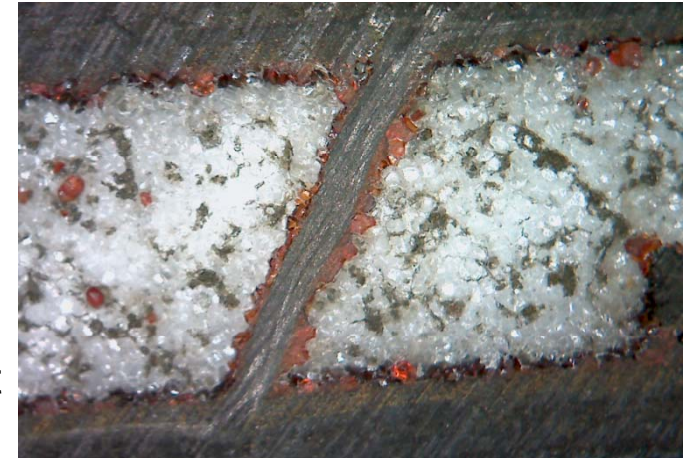
Pin-Deckschichtanbindung nach der Aushärtung
