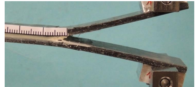
PU-Klebstoff: Substratbruch im oberen Biegearm
