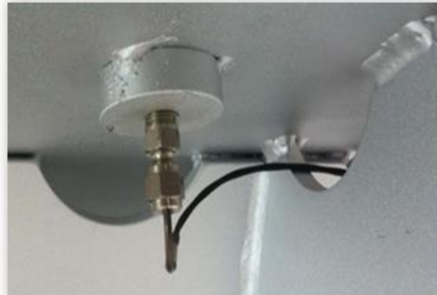
Temperatursensor am Formwerkzeug
